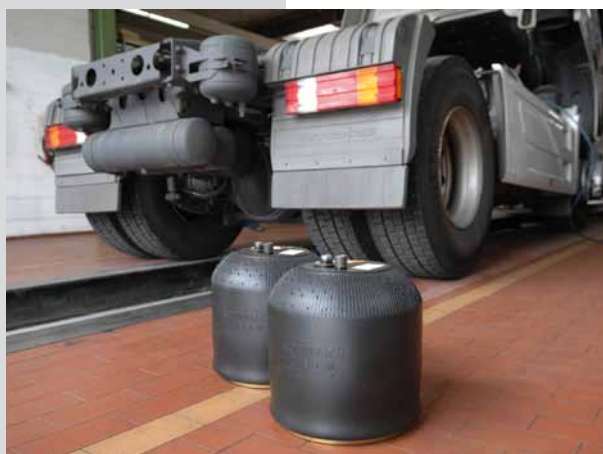
Moderne Sattelschlepper ruhen heute oft auf schonenden Luftfederungen. Den gewaltigen Luftdruck innerhalb der Behälter regulieren „Bälge“ aus Kautschuk und Gummi.
